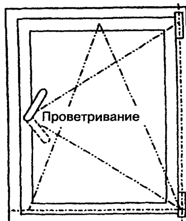
Рисунок А.4. Устройство поворотно-откидное (откидное, поворотно-откидное) с функцией регулируемого проветривания
